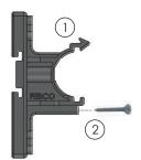
Detalle colector plástico montado en caja Ferco con carril Omega.
