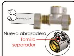
Quitar el casquillo de la pieza, introducirlo en la tubería y finalmente introducir el accesorio en el tubo. Debe estar engrasado.
